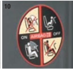
**10. ABSCHALTBARE BEIFAHREAIRBAGS** mit LED-Anzeige im Instrumententräger für den sicheren Einbau eines Kindersitzes auf dem Beifahrersitz.
